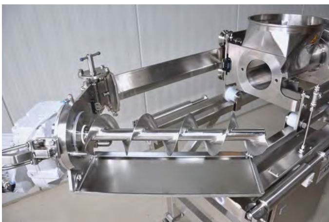
Защита от просыпания при извлечении дозирующего модуля предотвращает загрязнение
