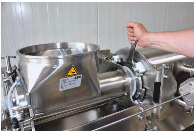
Различные возможности соединения дозирующего и ситового модулей: байонетное соединение, фланцевое соединение, сварка
