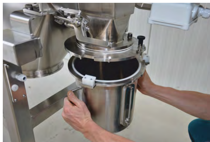
Сборный контейнер для крупной фракции с байонетным соединением для простого демонтажа без инструментов
