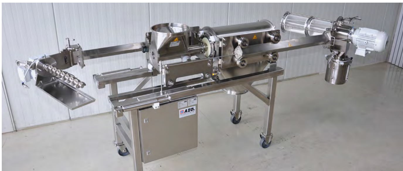
Сторону сита и сторону подачи можно вынимать и поворачивать в сторону для быстрой проверки и очистки
