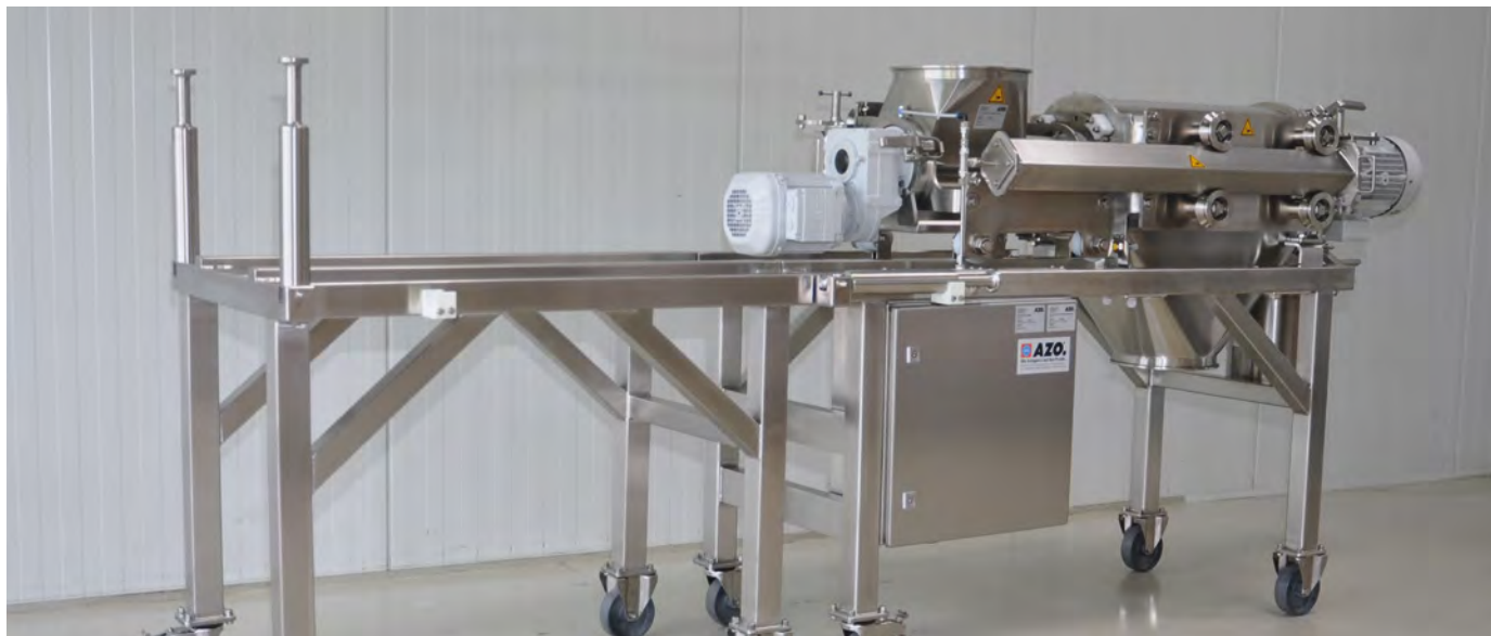
Вихревой просеиватель модели DA 650 Vario в передвижной раме с готовой к подключению системой управления
