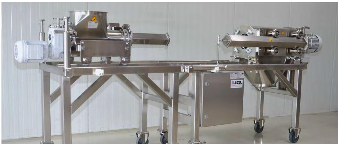
Рама для простого монтажа сменных дозирующих модулей
