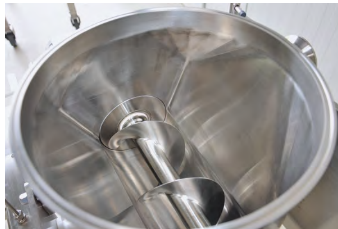
Входная область без зон застоя продукта сводит к минимуму остатки в дозирующем модуле
